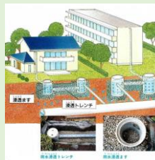
雨水浸透施設（浸透ます、浸透トレンチ）の設置イメージ
