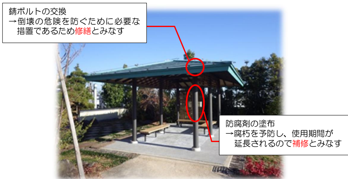
図 7-1 修繕と補修の例
