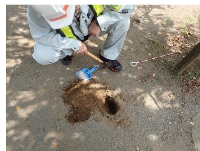
三角ホーによる土壌採取
