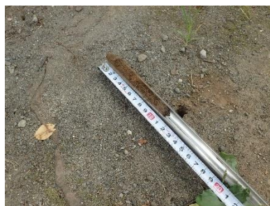
長谷川式検土杖 土壌採取調査風景
