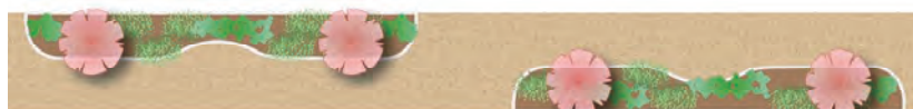
植栽帯と歩道を分離して安全安心な通路確保と根元保護を両立します
