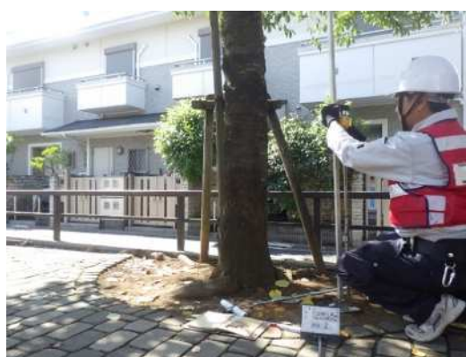
長谷川式土壌貫入試験状況
