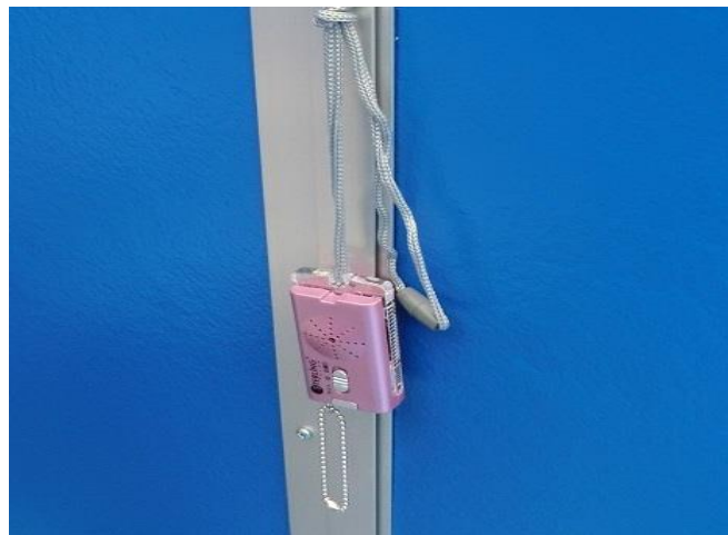
転倒時等に外部に知らせるためのブザー
