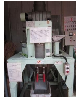
＜生ごみ堆肥化機械＞
