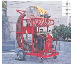
소형 소방 펌프
