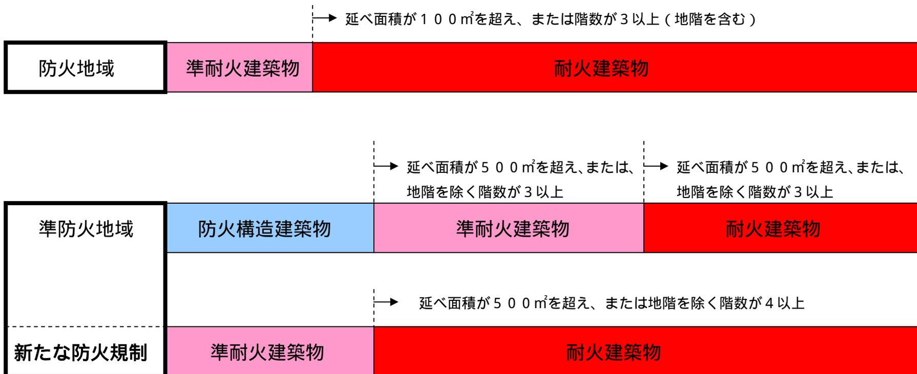
耐火建築物とは・・・鉄筋コンクリート造、鉄骨造の主要構造部に耐火被覆をしたものなど（現在では個別認定を受けた木造も可能です。）
