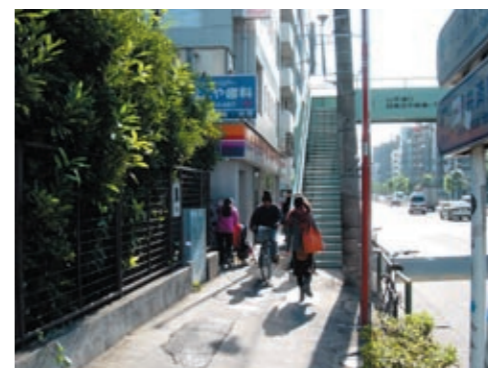
17) 山手通りやわた歩道橋 ・階段により歩道の有効幅員が阻害されている。
