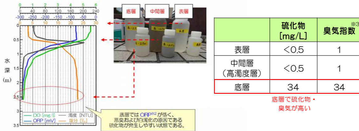
図5 目黒川太鼓橋地点における水質調査結果（深さ方向の水質分布）
